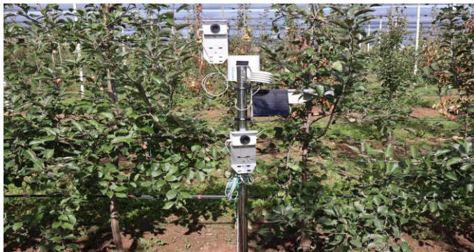
Slika 37. Kamera CropView METEOS® od Pessl Instruments za praćenje fenofaza razvoja biljaka (Izvor: Pessl Instruments GmbH)
