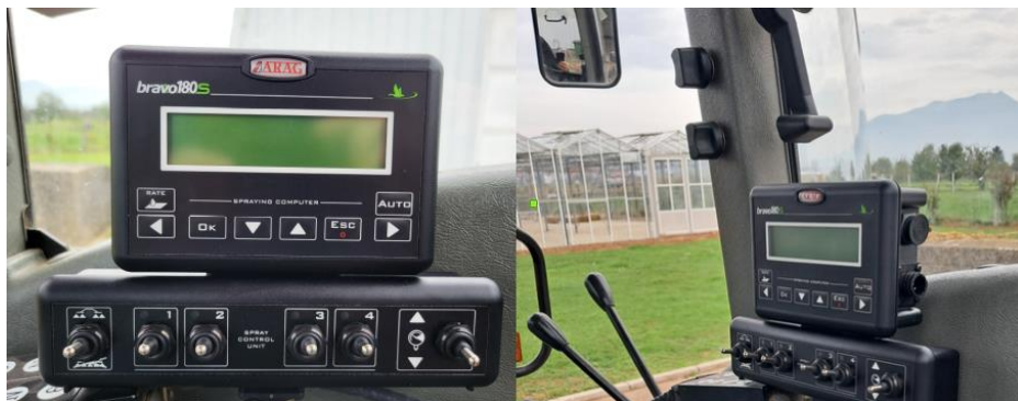
Slika 35. BRAVO 180s u kabini traktora
