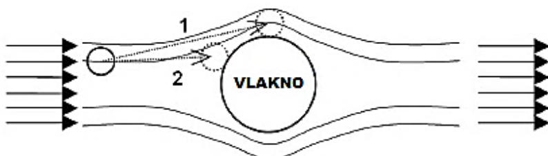
Slika 37. Ilustracija mehanizma filtracije direktnim (1) i inercijalnim sudarom (2) (Wen i sar., 2015)
