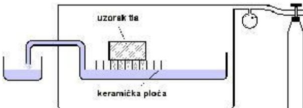
**Slika 52. Šema tlačnog ekstraktora ili aparata pod pritiskom za određivanje vodnih konstanti tla (pF) po Richardsu (izvor [126])**
