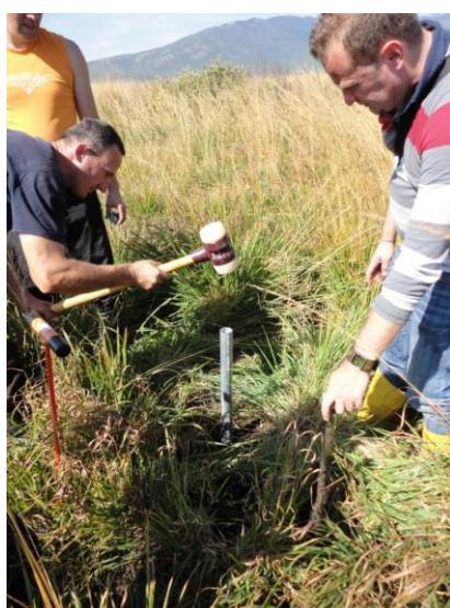
**Slike 63. i 64. (lijevo) Pijezometri; perforirane pocičane cijevi, zašiljene na vrhu (20-tak cm vrh), sa taložnikom 7 cm, rupe unakrsne promjera 3 mm u visini 70 cm od taložnika; filter na pijezometru: 4 x sloj medicinske gaze i 2 x sloj plastične mreže, učvršćeno na 4 mesta plastičnom steznikom, krajevi zalijepljeni ljepljivom trakom. (desno)Pijezometri se zabijaju u tlo najčešće do nepropusnog sloja. (vlastiti izvor) (foto: Ceric M.)**
