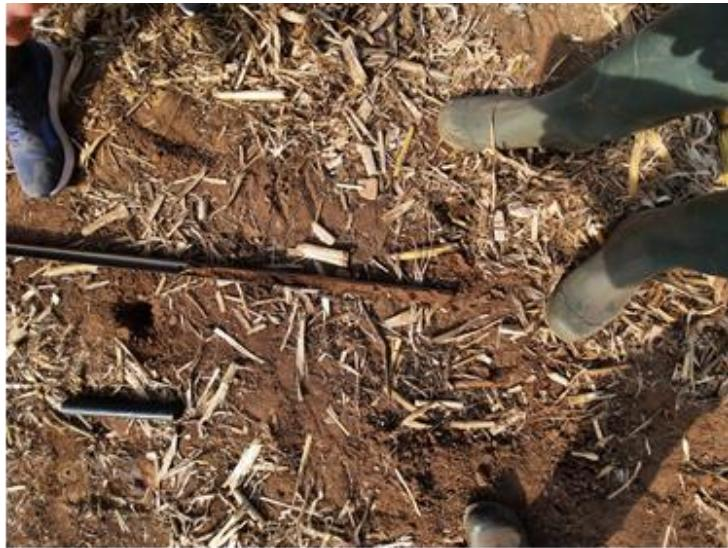
**Slika 9. Sondiranje zemljišta, na jezgru tla izvučenog sondom
