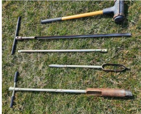
**Slika 7. Sonde (odozdo prema gore): sonda za uzorkovanje obala i terena sa visokim nivoom podzemne vode, Edelmanovo svrdlo sa produžetkom i obična sonda sa čekićem za nabijanje (photo: Tvica M.)**
