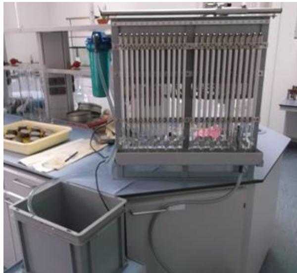
**Slika 55. Ejkelkamp - Laboratorijski permeametar** (foto: Trica M.)
