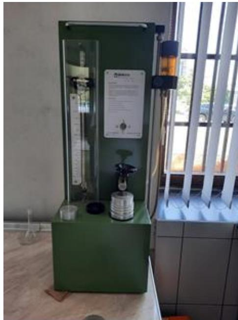
**Slika 43. Zračni piknometar proizvođača Eijkelkamp** (foto Tvica M.)
