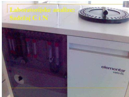
**Slika 34. Elementarni CN analajzer (foto Tвica M.)**
