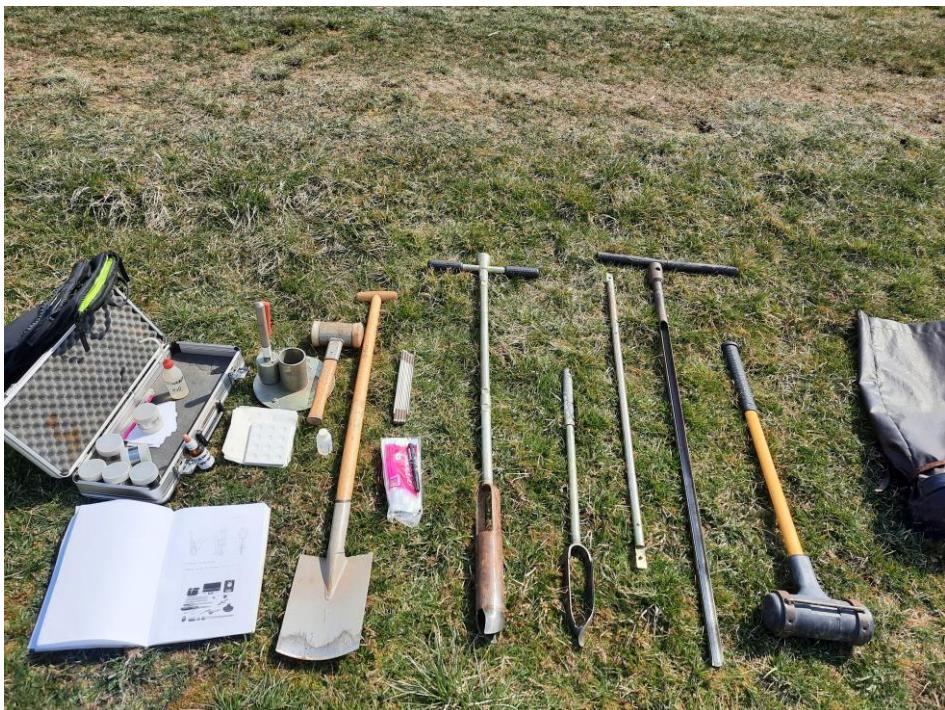
**Slika 8. Oprema i pribor za sondiranje zemljišta, iskop profila, uzimanje pojedinačnih i prosječnih uzoraka tla** (photo: Tvica M.)
