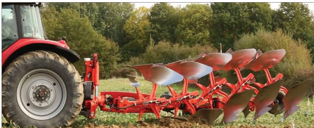
Slika 88. Postepeno, pojedinačno i ravnomjerno zabražđavanje plužnih tijela
