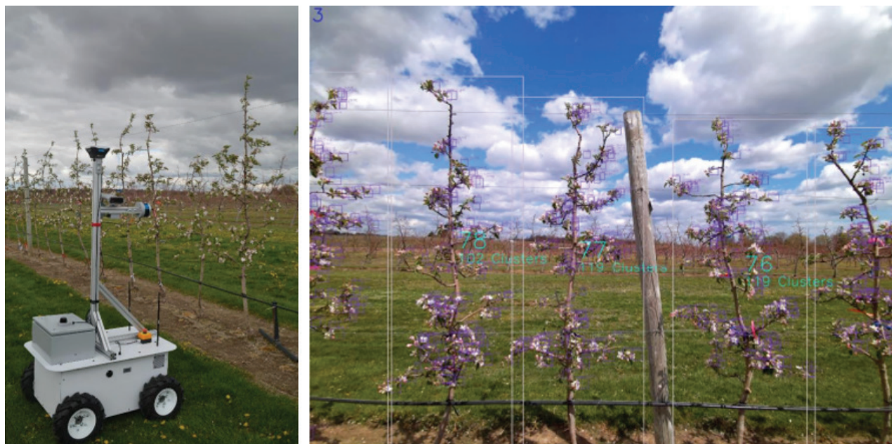
Slika 55. Izgled uređaja za prikupljanje podataka (lijevo) i izgled snapshot video detekcije sa brojevima cvasti po stablu (desno) upotrebom YOLOv5 algoritma (Lee, 2022)
