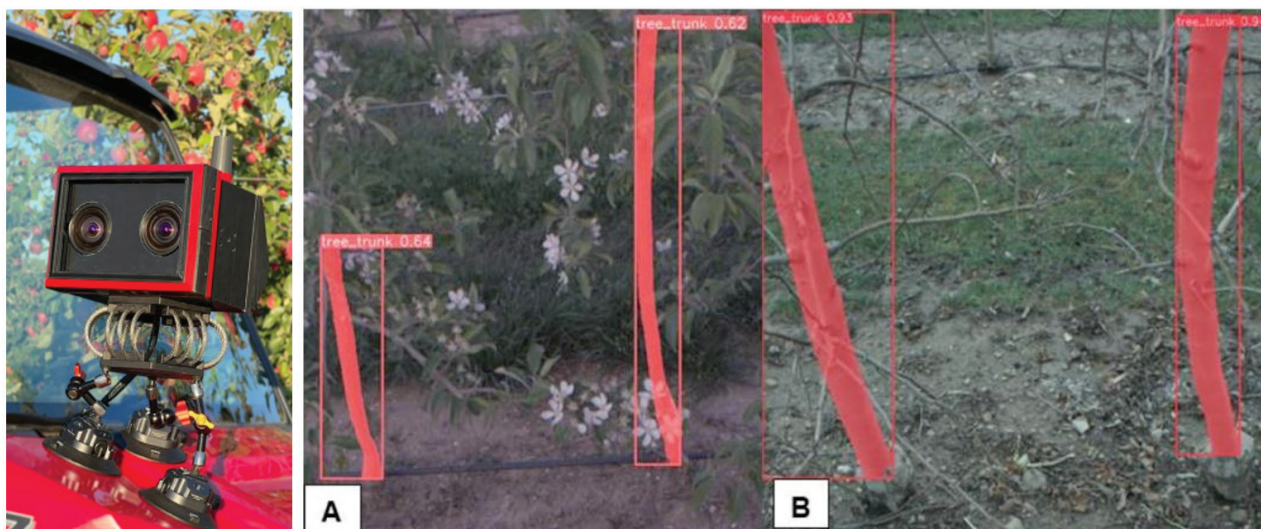
Slika 53. Izgled sistema kamera „Orchard Robotics visual system“ i izgled slike sa vrijednostima TSCA nakon softverske obrade
