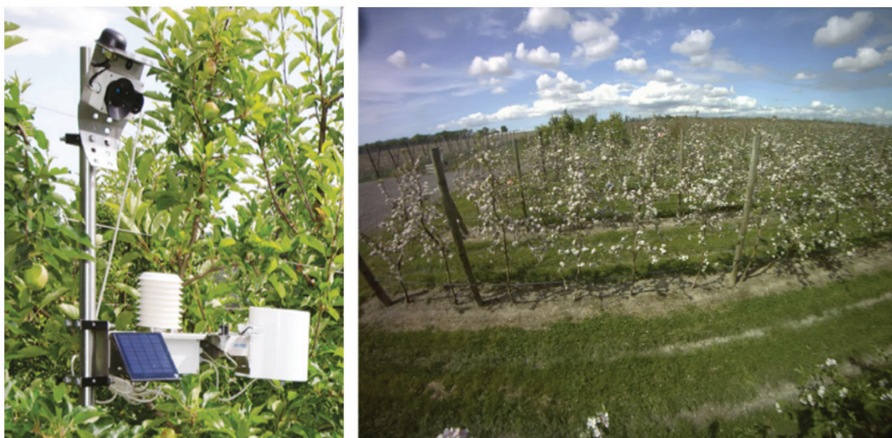
Slika 51. Izgled postavljene kamere u sklopu meteorološke stanice – lijevo; izgled kadra (široki ugao) – desno (izvor: https://metos.global/en/cropview/ ).
