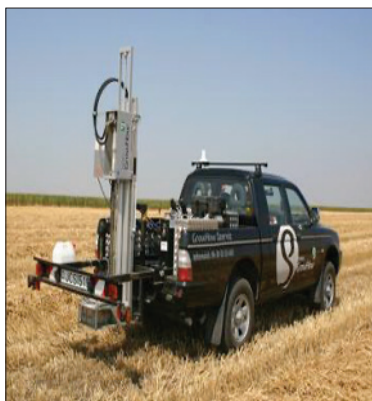
Slika 2. Nošeni-vučeni uređaj sa sondom za uzimanje uzoraka tla (Izvor: https://www.carneuse.com/eu-en/support/field-support ).
