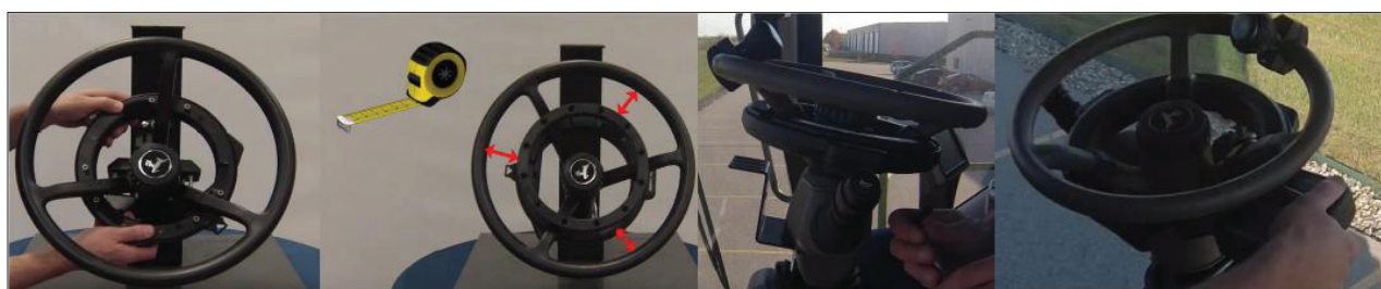
Slika 86. Postavljanje aktuatora na upravljački uređaj - Ag Leader's SteadySteer (Izvor: https://www.youtube.com/watch?v=3cYQpu4Mm9w ).
