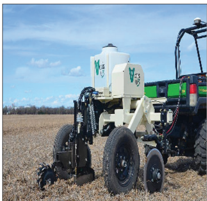
Slika 1. Veris U3 koristi tri vrste senzora za izradu pristupačnih karata: pH i EC vrijednost i sadržaj organske materije (izvor: https://topfarms.com/technology/7,7-soil-testing-with-the-veris-u3-scanner ).
