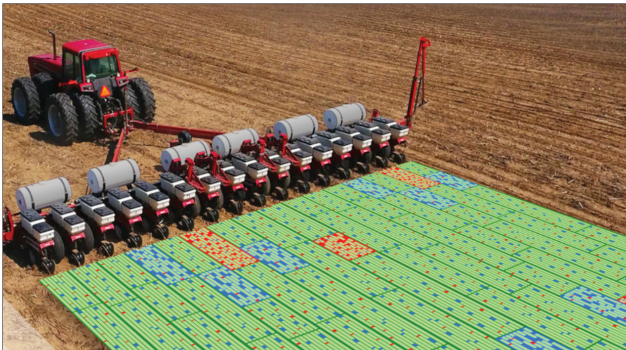
Slika 70. Šematski prikaz heterogenog polja i rada precizne sijačice
