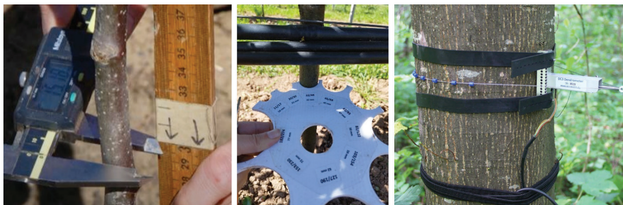
Slika 52. Mjerenje prečnika debla uz pomoć digitalnog šublera (lijevo), šablona (sredina) i dendrometra (desno)
