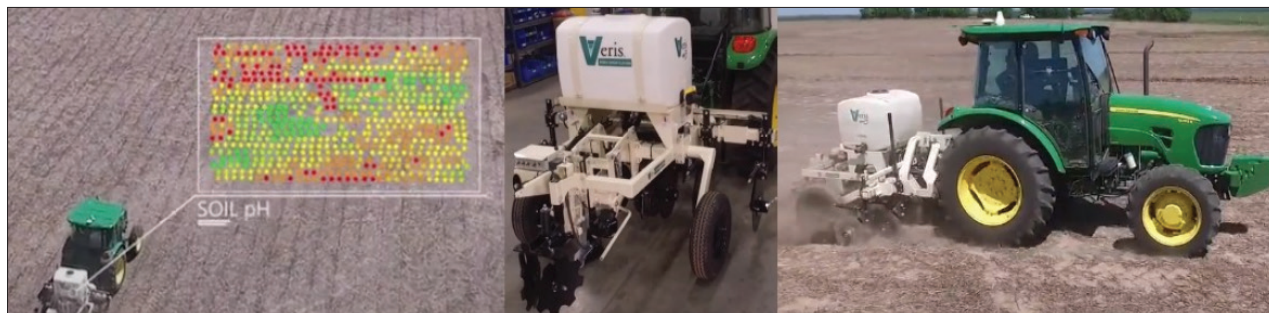
Slika 87. Senzori Veris MSP3 platforme omogućava mapiranje tri svojstva tla u jednom prolazu (Izvor: https://www.youtube.com/watch?v=ND-gPCux3DY&t=34s ).
