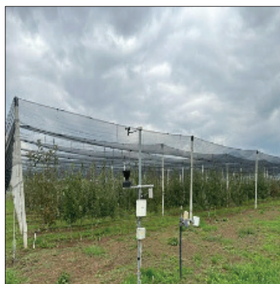
Slika 14. Meteorološka stanica za mjerenje meteoroloških (vremenskih) podataka
